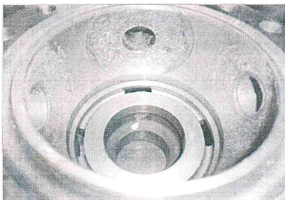
CAIXA SATÉLITE DESMONTADA - DETALHE DE COMPONENTE AVARIADO
